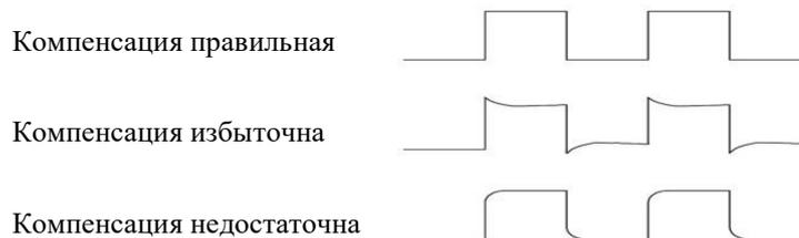
3. Если необходимо, используйте неметаллическую отвертку, чтобы настроить переменную емкость щупа до получения формы сигнала, соответствующей рисункам выше. При необходимости повторите этот шаг. См. рисунок ниже для способа настройки.
