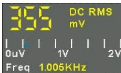
На дисплее в середине окна цифрового вольтметра отображается соответствующее отношение текущего измеренного значения напряжения к диапазону, соответствующему восьми вертикальным сеткам на экране с выбранным вольт / делением (поверните ручку вольт / деления).
