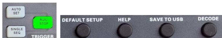
**Auto Set:** автоматическая настройка органов управления осциллографа для создания удобного отображения входных сигналов. См. Относительное содержание в следующей таблице.
